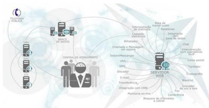
A Solução ExtendVoIP é um Softswich que utiliza placas de telefonia analógicas ou digitais (fxs/fxo/ E1) permitindo a comunicação desses meios por conexão IP, utilizando o padrão de protocolo R2/ISDN adotados no Brasil.
